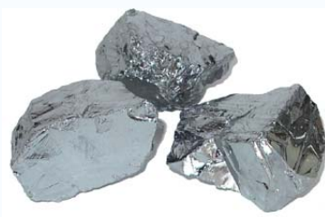
Crystalline Silicon 99% pure
